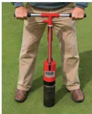
Den HIO Lochbohrer vertikal aufstellen. Dann den Splint herausziehen.
