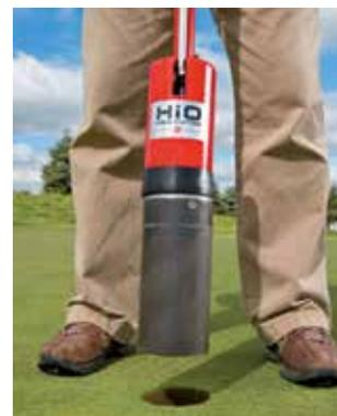
Den HIO Lochbohrer am alten Loch ansetzen. Einen Fuß gegen die Klinge setzen und den Auswurfgriff ziehen, so dass der "Bohrkern" aus der Erde heraus gedrückt wird.
