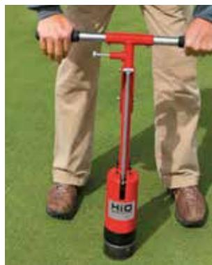
Die Klinge bis zu der schwarzen Linie in den Boden treiben. Den Splint eindrücken und den Bohrer anheben.
